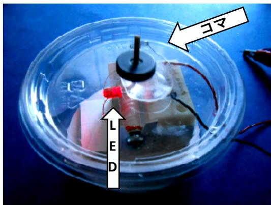
コイルや磁石を使った工作で、コマが長時間回り続けるよ。LEDも点灯するよ。上手に作ると空中で回転するコマができるよ。
